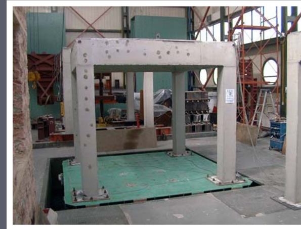
Δοκιμή μετά τη φάση ωρίμανσης (ΟΑΣΠ)
