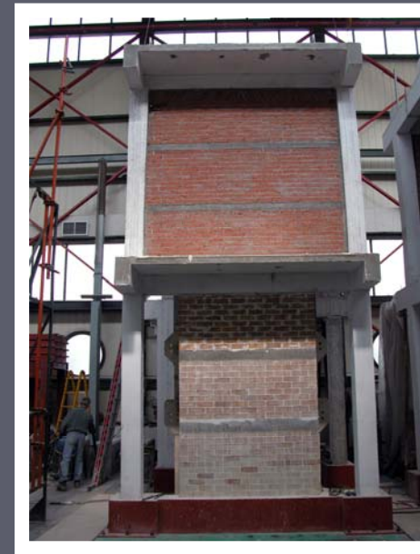
Επισκευή με τοιχοπήρωση στο ισόγειο από συμπαγή τούβλα (ΟΑΣΠ)
