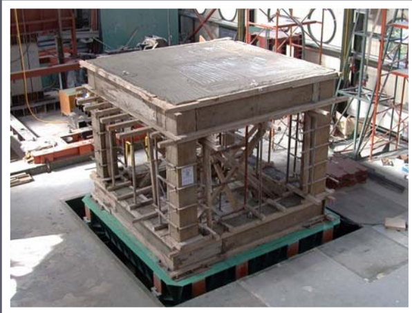
Δοκιμή κατά τη φάση σκυροδέτησης (ΟΑΣΠ)
